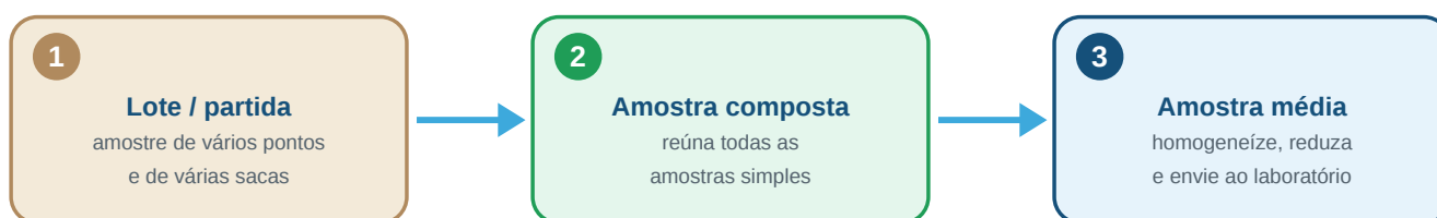
Figura 1. Da partida à amostra média enviada ao laboratório (a amostra de trabalho é obtida no laboratório).
